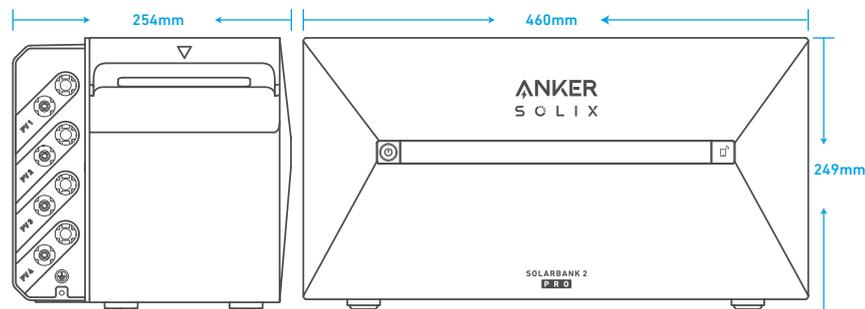
Abbildung: Anker SOLIX BP1600 Erweiterungsakku
